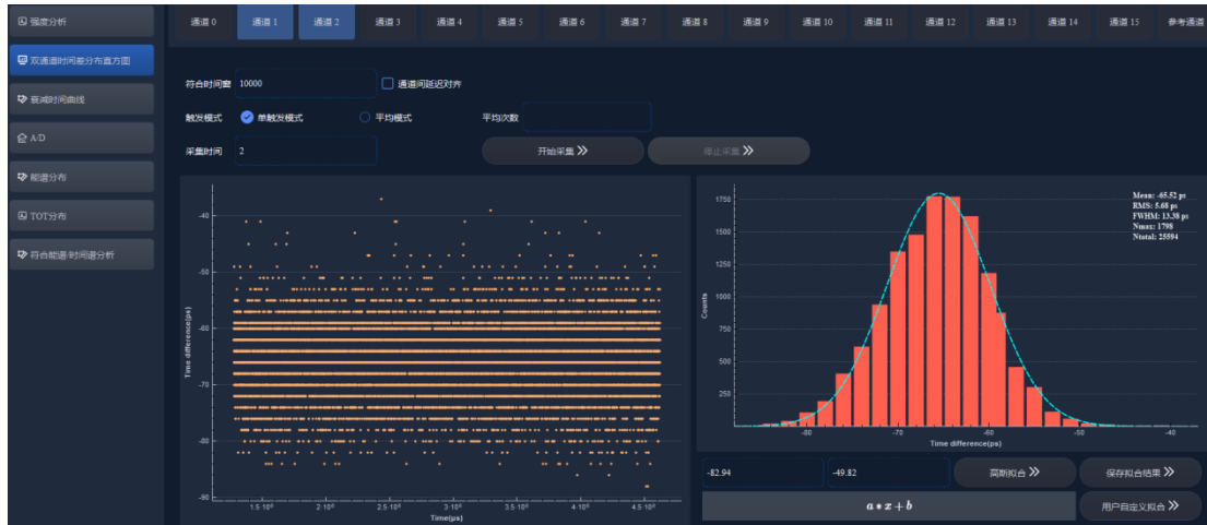
图 104 Venus 设备 2 的 CH1 和 CH2 时间差分布（内部触发，上图：使用本地 TDC 时钟；下图：使用上一级 Venus 设备 1 的输出时钟）
