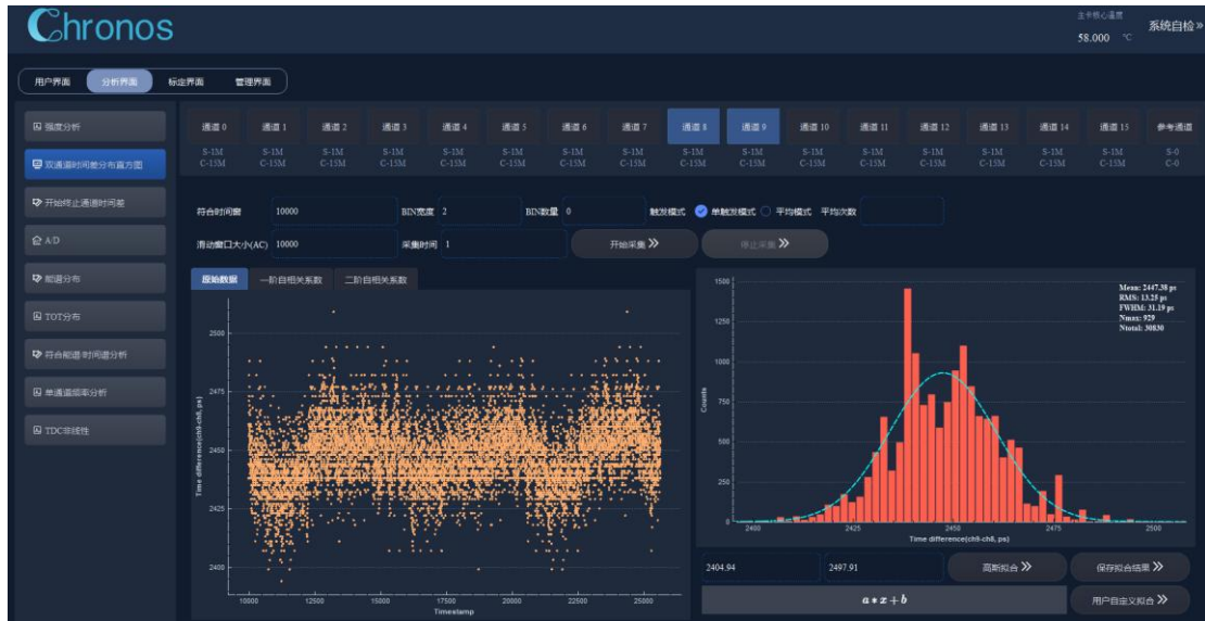
图 82 双通道时间差外部输入信号测量结果（普通通道，通道 8 和 9，上升沿，典型结果）
