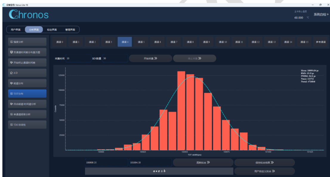
图 88 TOT 外部输入信号测量结果（普通通道，通道 4，典型结果）
