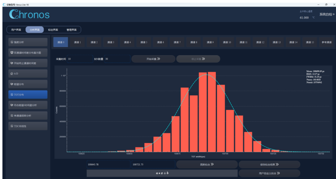
图 87 TOT 外部输入信号测量结果（高分辨率通道，通道 0，典型结果）
