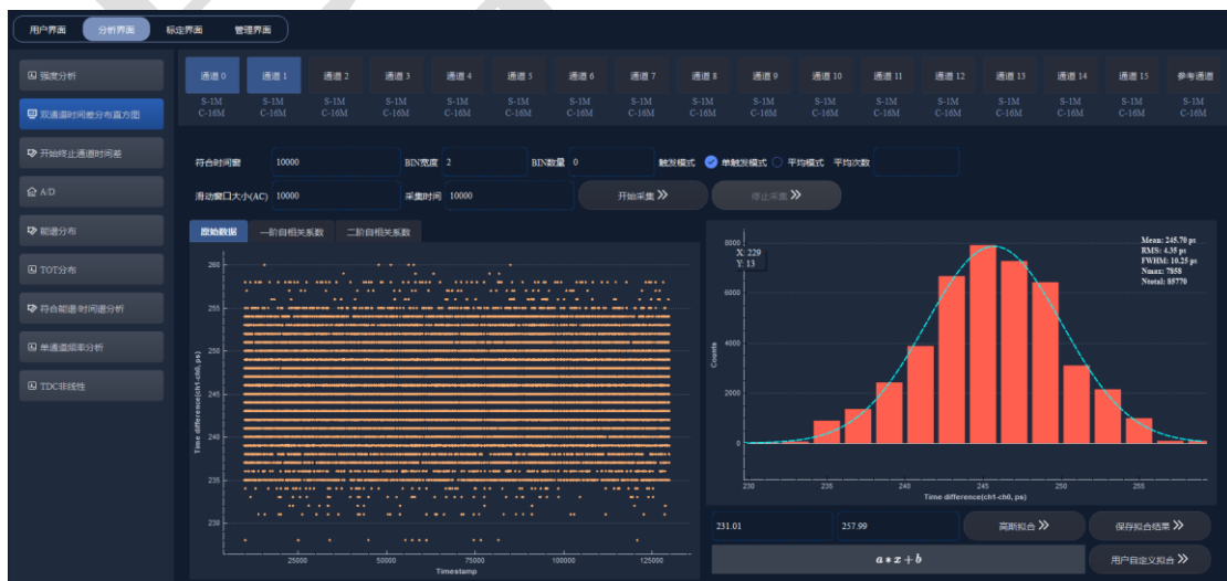
图 77 高分辨率通道双通道时间差分布直方图典型测试结果（内部触发，上升沿，CH01）
