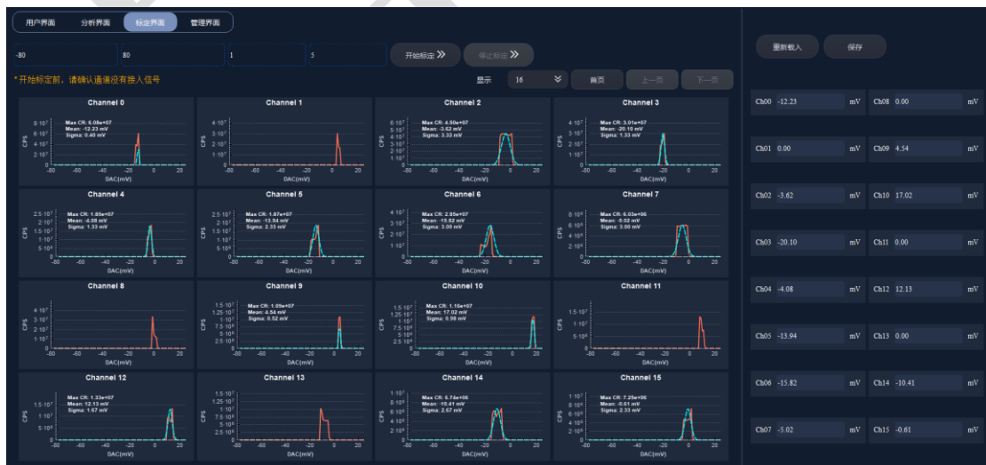
图 75 系统标定结果（迟滞电压 1 mV，标定范围-100 mV 到+100 mV，步进值 1 mV，平均次数 5，典型结果）
